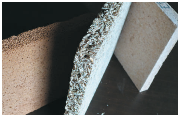
Fabrication de panneaux de particules biosourcés (source : CoDEM-Le BatLab)
